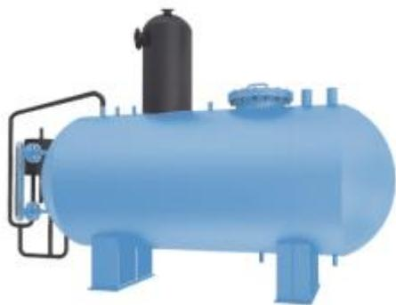
Бак деаэрационный БДА входит в состав специальной установки – деаэратора ДА, которая удаляет коррозионно-агрессивные газы (кислород и свободную углекислоту) из питательной воды в паровых котлах и из подпиточной воды в системах теплоснабжения.
