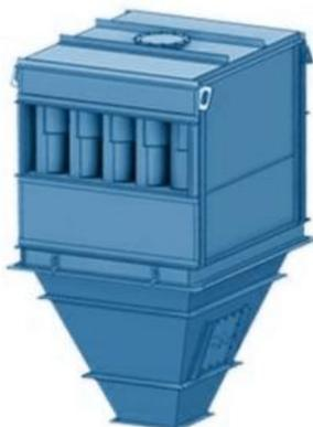
Циклон батарейный ЦБ-49 предназначен для очистки запылённых газов или воздуха от твёрдых частиц неслипающейся пыли или золы с размерами частиц более 5 мкм.
