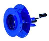
Горелки газомазутные ГМ-2,5 предназначены для раздельного сжигания природного газа и топочного мазута и используются с паровыми газомазутными котлами типа ДЕ-ГМ, а также с водогрейными котлами, разработанными на базе паровых котлов ДЕ-ГМ. Допускается кратковременное совместное сжигание газа и мазута во время перехода с одного вида топлива на другой.
