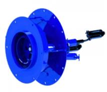
Горелки газомазутные ГМ-4,5 предназначены для раздельного сжигания природного газа и топочного мазута и используются с паровыми газомазутными котлами типа ДЕ-ГМ, а также с водогрейными котлами, разработанными на базе паровых котлов ДЕ-ГМ. Допускается кратковременное совместное сжигание газа и мазута во время перехода с одного вида топлива на другой.
