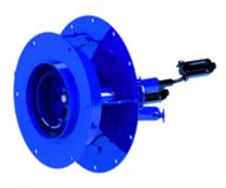
Горелки газомазутные ГМ-10 Бийского Котельного Завода «Генерация» предназначены для раздельного сжигания природного газа и топочного мазута и используются с паровыми газомазутными котлами типа ДЕ-ГМ, а также с водогрейными котлами, разработанными на базе паровых котлов ДЕ-ГМ. Допускается кратковременное совместное сжигание газа и мазута во время перехода с одного вида топлива на другой.
