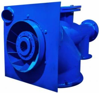
Горелки газомазутные ГМГ-4,0 Бийского Котельного Завода «Генерация» предназначены для раздельного сжигания природного газа и топочного мазута и используются с паровыми котлами типа ДКВр с газомазутными топками, а также с водогрейными котлами, разработанными на базе указанных паровых котлов.
