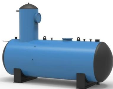
Предназначен для удаления коррозионно–агрессивных газов (кислорода и свободной углекислоты) из питательной воды системы теплоснабжения при одновременном её нагреве. Основными элементами деаэратора ДА-25/15 являются: деаэраторный бак, деаэрационная колонка и гидрозатвор. Деаэраторный бак представляет собой горизонтальный, цилиндрический сосуд с эллиптическими днищами и патрубками входа и выхода рабочей среды, подключения трубопроводов и арматуры. Бак имеет две опоры, одна из которых подвижная.
