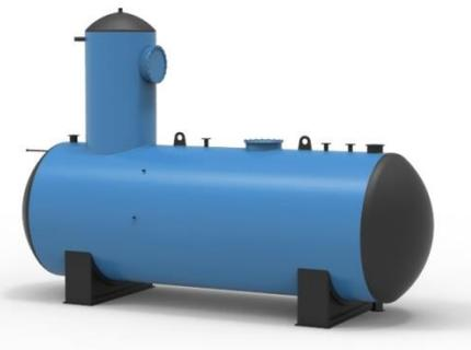
Предназначен для удаления коррозионно–агрессивных газов (кислорода и свободной углекислоты) из питательной воды системы теплоснабжения при одновременном её нагреве. Основными элементами деаэратаора ДА-25/15 являются: деаэраторный бак, деаэраторная колонка и гидрозатвор. Деаэраторный бак представляет собой горизонтальный, цилиндрический сосуд с эллиптическими днищами и патрубками входа и выхода рабочей среды, подключения трубопроводов и арматуры. Бак имеет две опоры, одна из которых подвижная.
