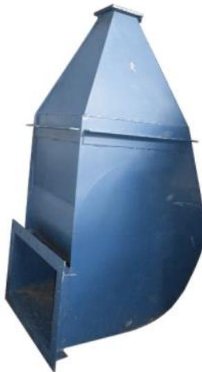
Золоуловитель ЗУ-1-2 (левый) представляет собой горизонтальный циклон, предназначенный для сухой инерционной очистки газов с максимальной температурой 280°C от частиц золы с размером более 50 мкм.
