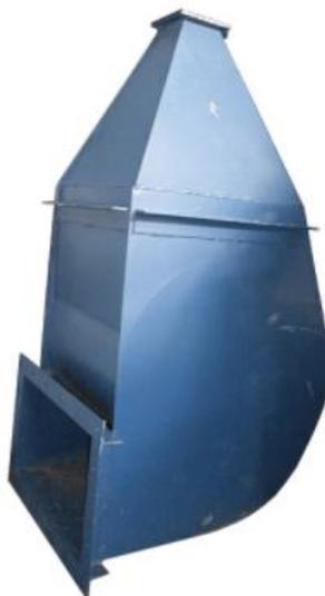
Золоуловители ЗУ 2-1 (правый) представляет собой горизонтальный циклон, предназначенный для сухой инерционной очистки газов с максимальной температурой 280°C от частиц золы с размером более 50 мкм.
